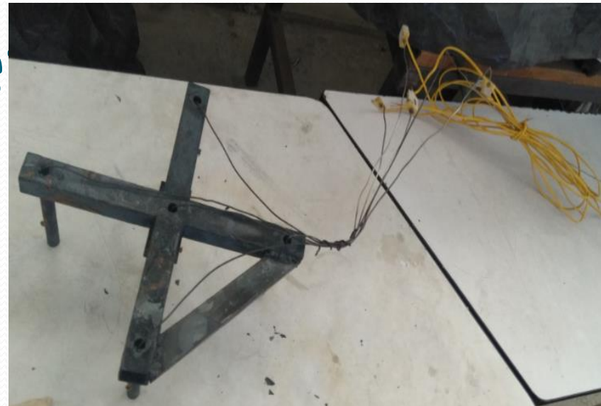
Imagen 3. Sistema de sujeción de las probetas.
